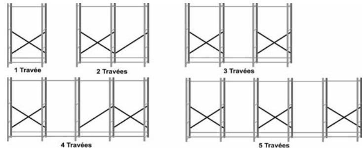
Tableau de pose des raidisseurs pour rayonnages/Brace installation diagram for shelving units
